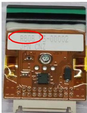
Каждая печатающая головка имеет индивидуальный уровень сопротивления и настройка уровня напряжения для каждой, отличается. На этикетке на печатающей головке указан уровень сопротивления для этой конкретной головки. В случае как на примере R=808.
