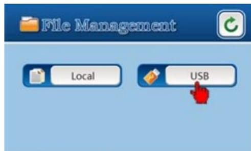
1. Вставьте USB карту в принтер. Войдите в раздел (Управление файлами) из основного окна в состоянии принтера «Готов».
