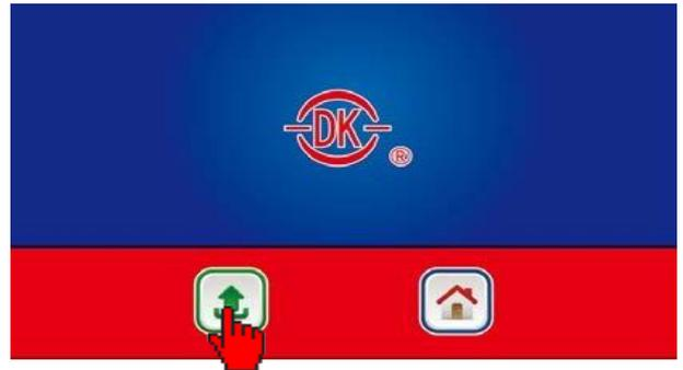
1. Сохраните обновление программного обеспечения на USB в папке с именем «dkupdate». Подключите USB к блоку контроллера. Включите блок управления.
