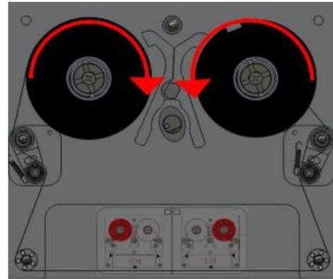
4. Проверните стопорную втулку, как показано в до ее фиксации.
